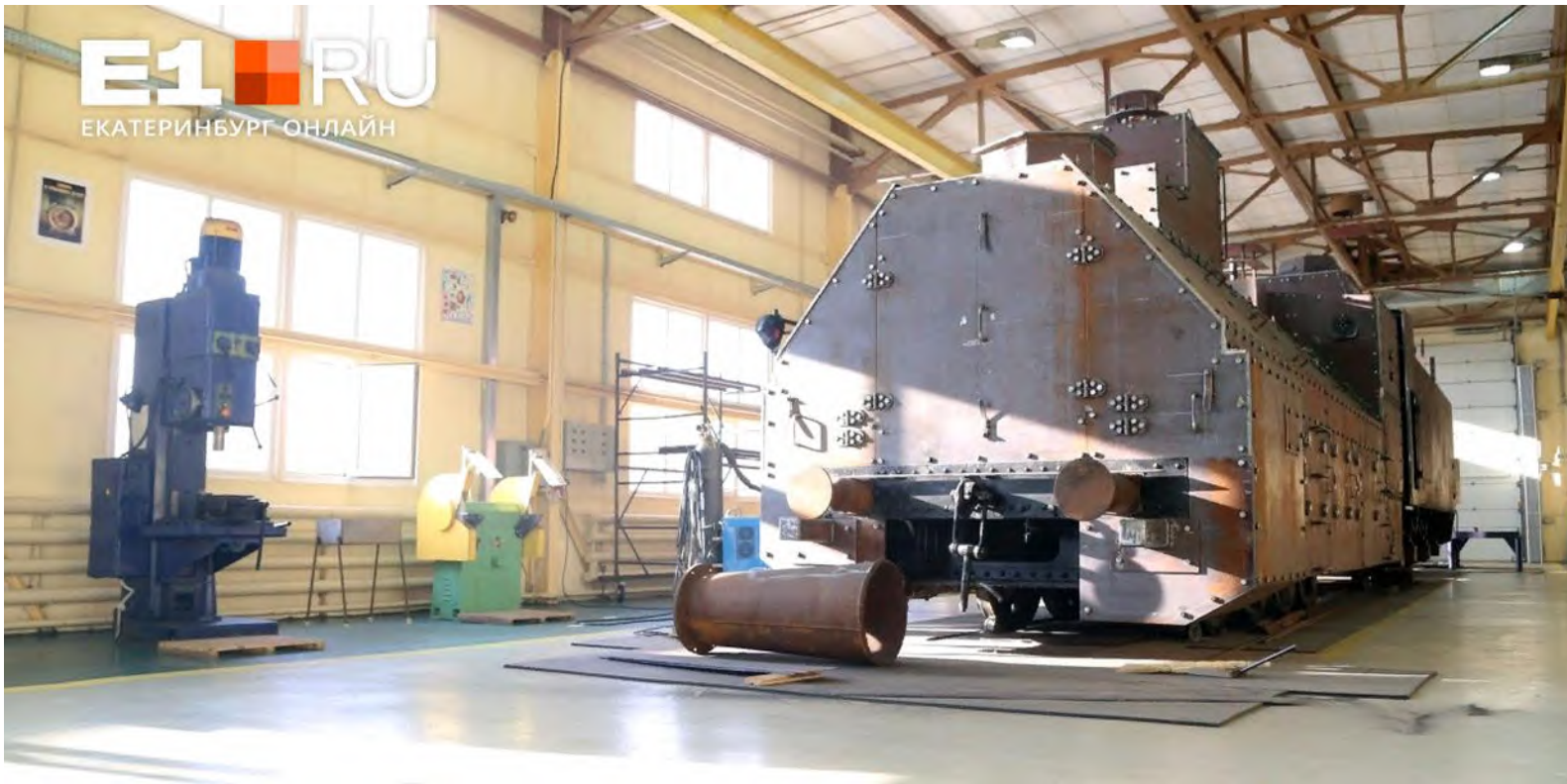
Строительство бронепоезда серии «БП-43»
